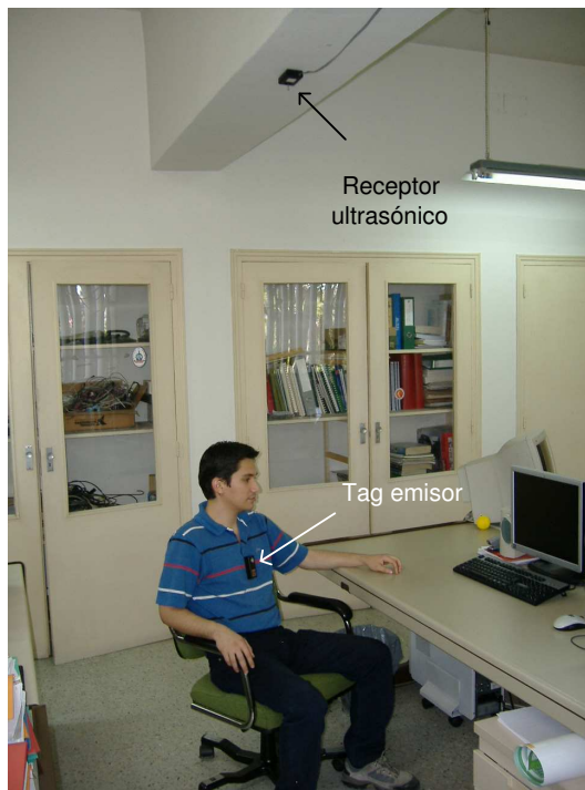
Figura 14: Foto del sistema implementado para las pruebas en la habitación grande. Se observa uno de los cuatro receptores ultrasónicos y el tag emisor.
