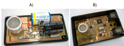
Figura 1: Componentes del sistema Hexamite: A) Tag emisor B) Lector ultrasónico
